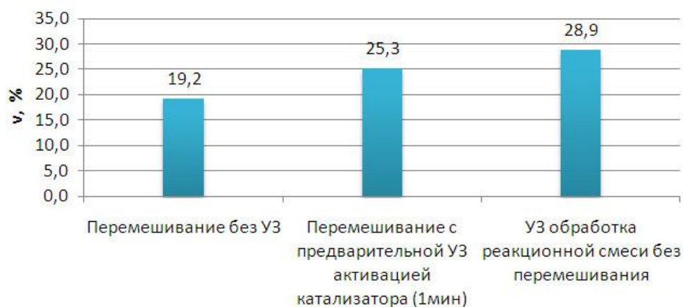
Рисунок 2. Зависимость степени очистки v от способа воздействия
