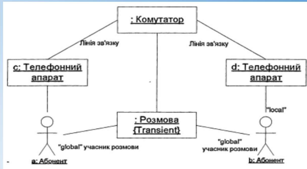
Рисунок 12.15 Фрагмент діаграми кооперації, доповнений стереотипами ролей зв'язків, іменами асоціацій і позначенням значенням об'єкта
