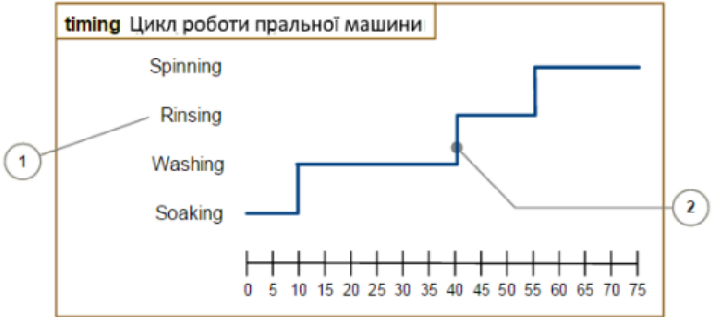
Рисунок 10.31 Нотація діаграми синхронізації ( 1 – стани різних екземплярів класифікаторів, 2 – часова синхронізація екземплярів класифікаторів)
