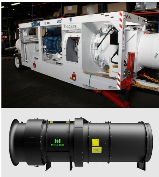
Рис. 1. Підземні допоміжні вентилятори: зверху — мобільний; знизу — стаціонарний. (Фото: Howden / Minetek).
