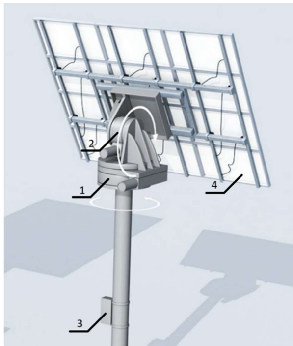
Рисунок 1.2 — Схема моделі двох осьової динамічної сонячної панелі
