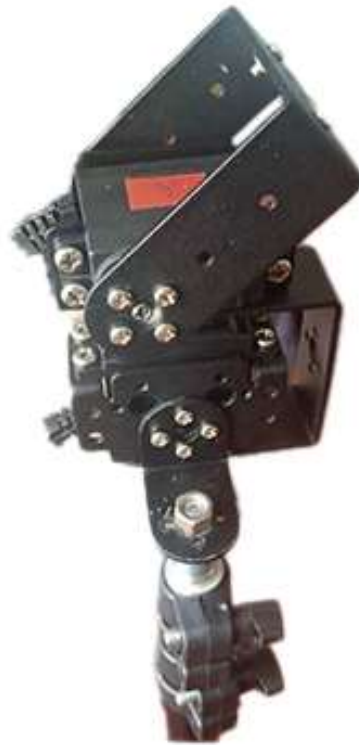
Рисунок 3.9 – Зібрана конструкція сервоприводів
