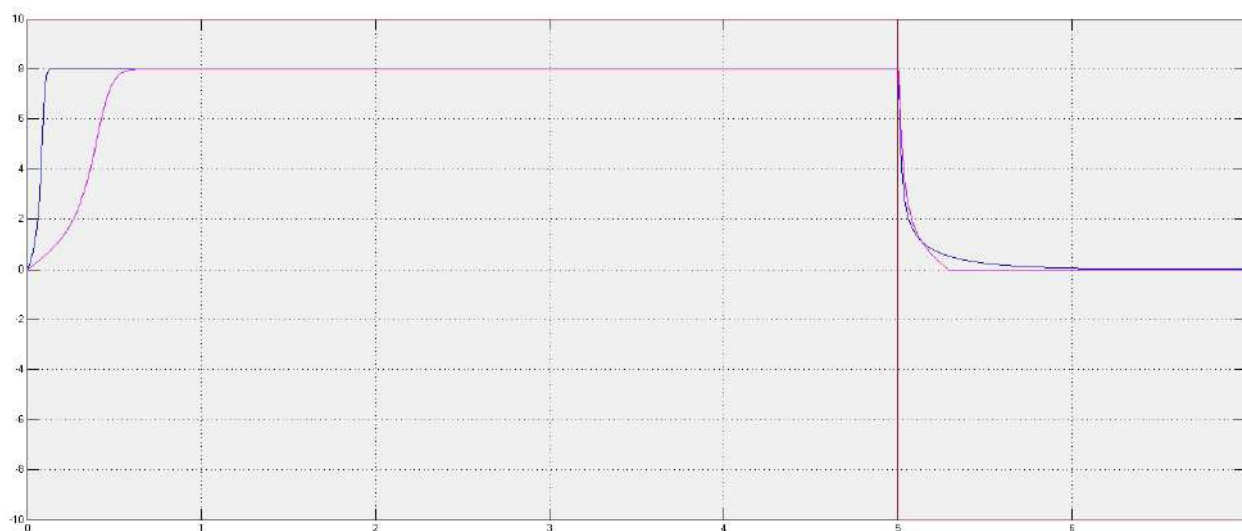
Рисунок 1.15 – Перехідні процеси зміни струму в обмотці гальма ковзання для двох способів керування: синя лінія – корекція негативним зворотним зв'язком, пурпурова лінія – керування з застосуванням біполярного керованого випрямляча [13]
