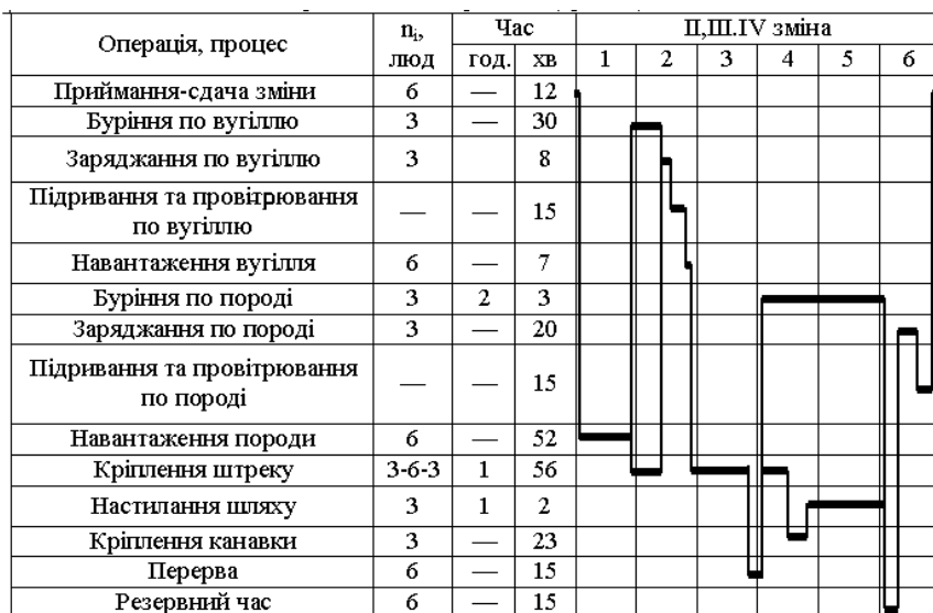
Рисунок 4.1 – Приклад графіку організації робіт при буровибуховій технології проведення виробки
