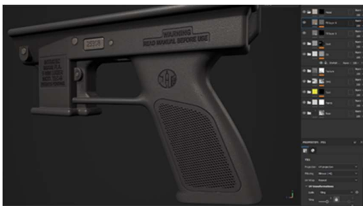
Рисунок 7. Текстурування моделі корпусу пістолета-кулемета у програмі Substance painter
