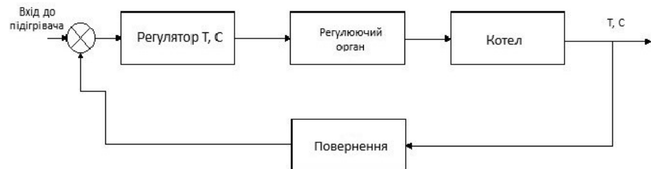
Рисунок 1 – Схема регулювання води на виході з котла
