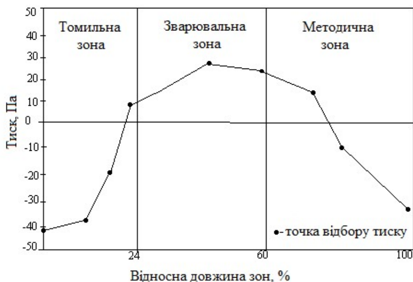
Рисунок 1. Зміни тиску, вимірюваного пневмометричною трубкою на діючій п'ятизонній методичній нагрівальній печі
