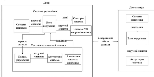
Рисунок 1. Загальна структурна схема розроблюваної роботизованої системи
