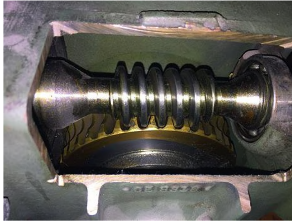
Рисунок 2.1 – Черв'ячний редуктор у розрізі
