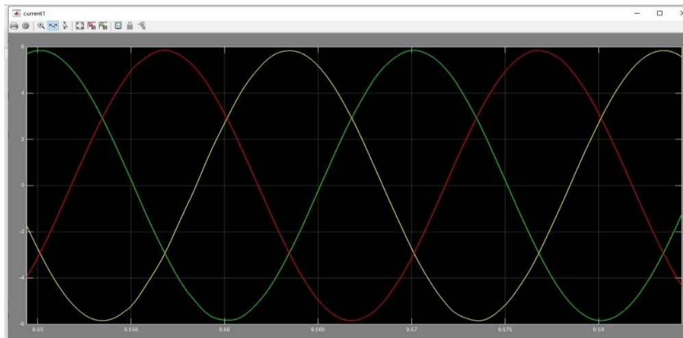
Рисунок 3.39 – Графік струму на стороні ВН при навантаженні 0.25 від номінального (40 кВт)
