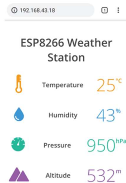
Рисунок 4. Показання BME280 на сторінці веб-сервера ESP8266
