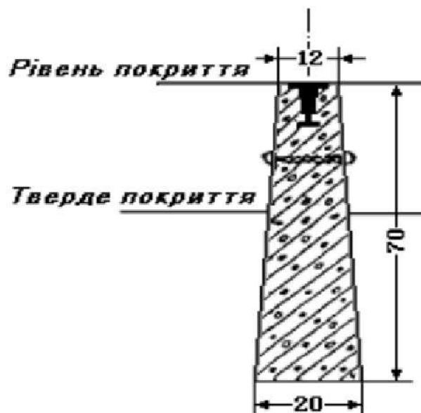
Рисунок 3.10 – Центр пункту полігонометрії, трилатерації і тріангуляції 4 класу, 1 і 2 розрядів для забудованих територій, райцентрів, міст, селищ, сільських населених пунктів (тип У15)
