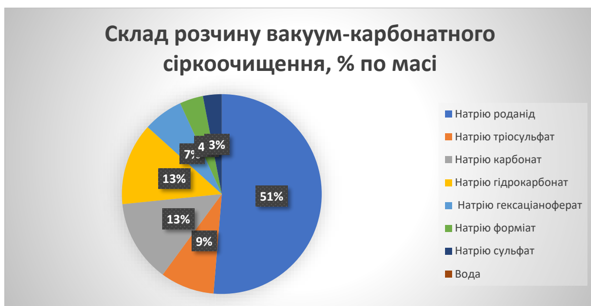
Рисунок 1.13 – Склад розчину вакуум-карбонатного сіркоочищення відпрацьованого
