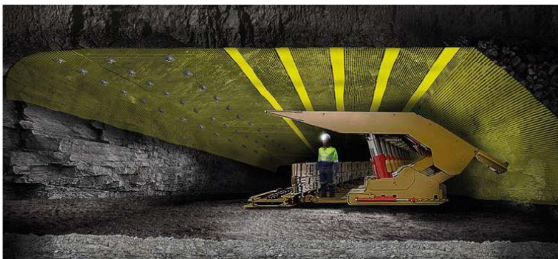
Рисунок 3.5 - Спрощене зображення демонтажної камери, сформованої відповідно до технології 1-ї групи із застосуванням полімерної сітки
