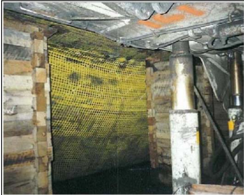
Рисунок 3.6 - Полімерна сітка стримує потрапляння порід з виробленого простору в демонтажні камеру
