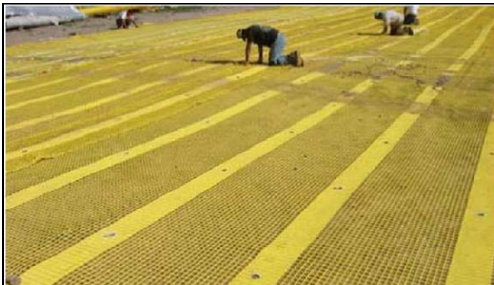
Рисунок 3.4 - Процес складання перекриття на заводі-виробнику перед відправкою споживачеві
