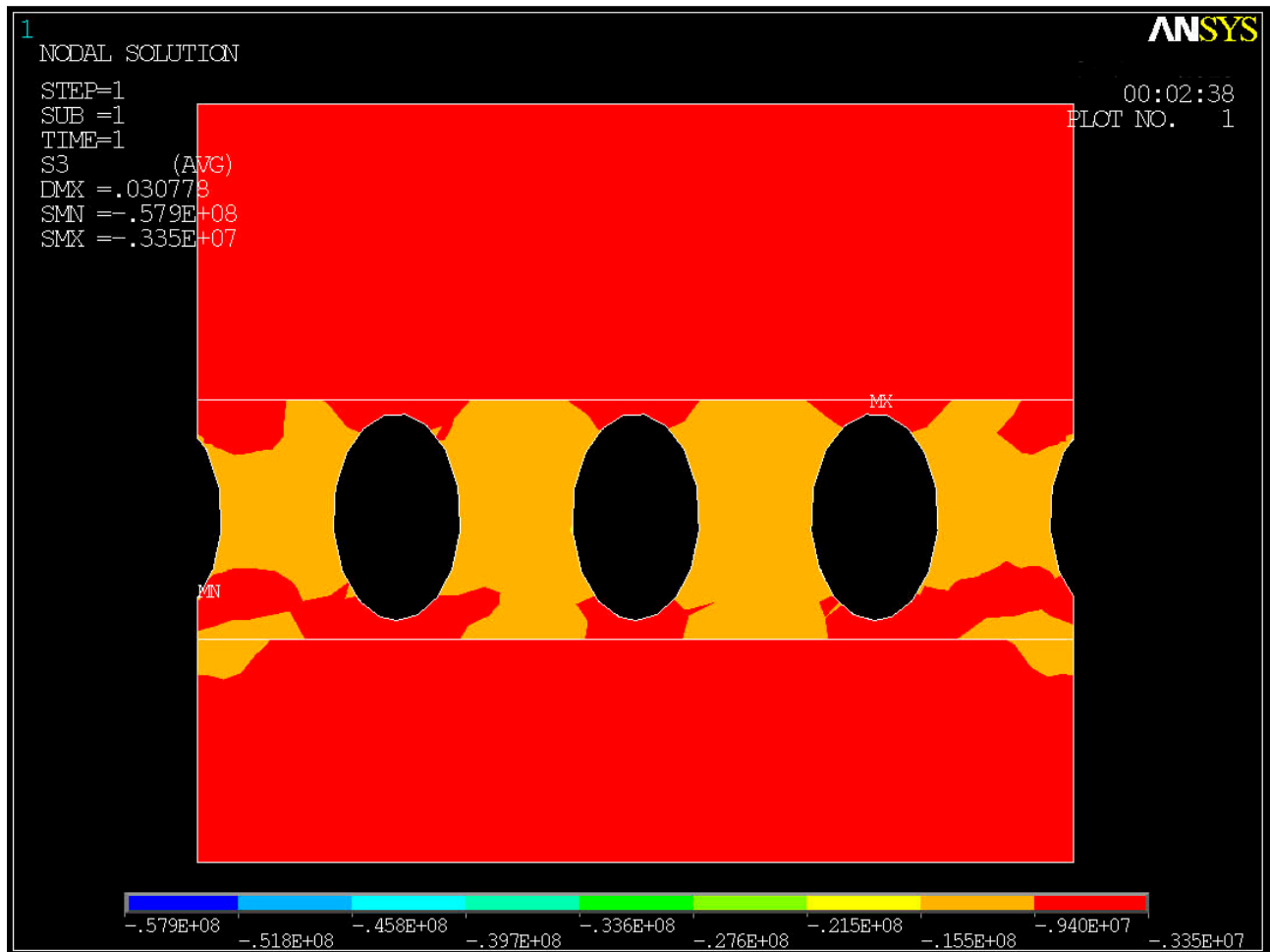
Рисунок 4.10. Розподіл мінімальних головних напружень навколо камер (міжкамерний цілик 12м)
