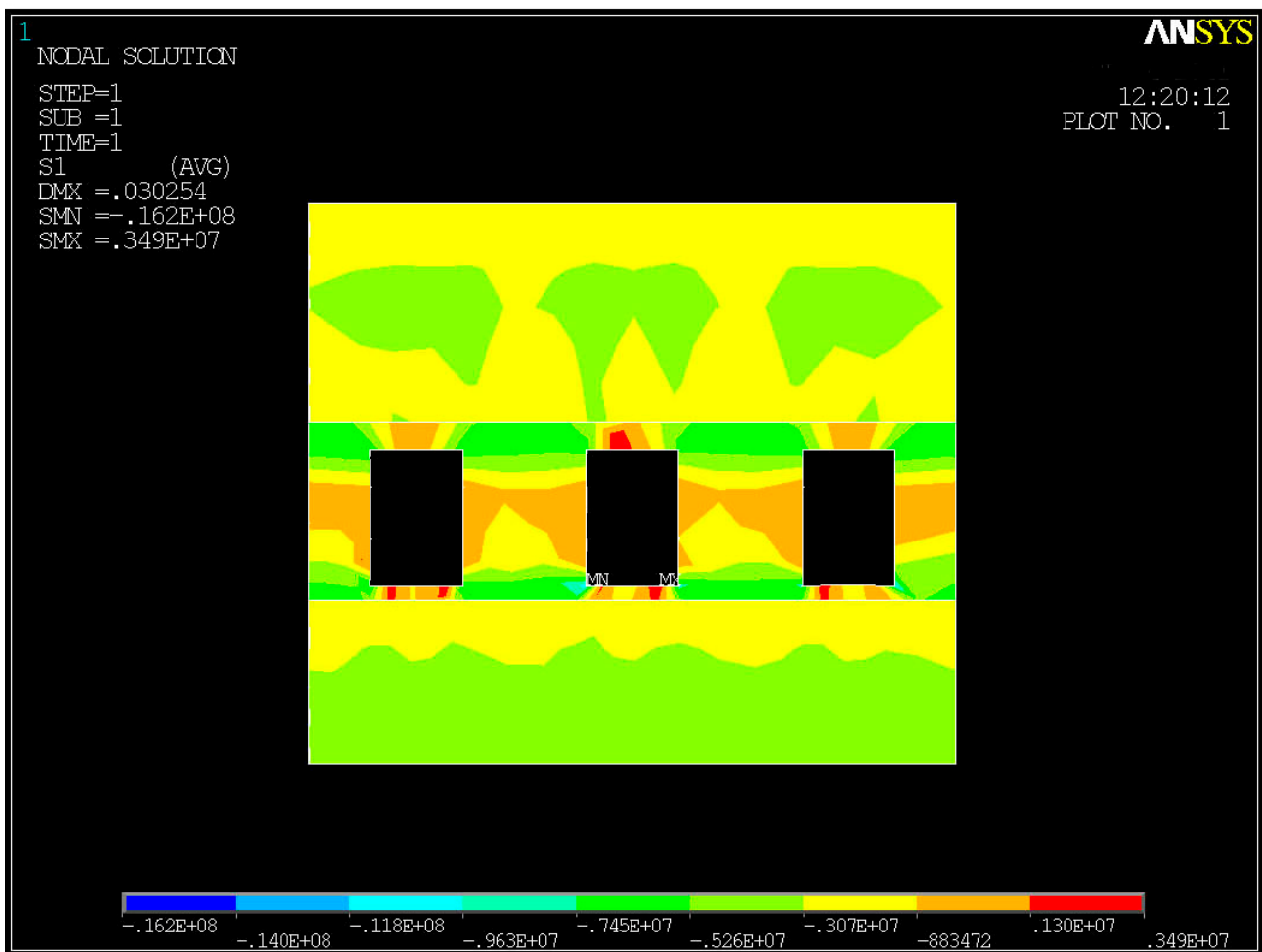
Рисунок 3.2 – Розподіл максимальних головних напружень навколо очисних камер
