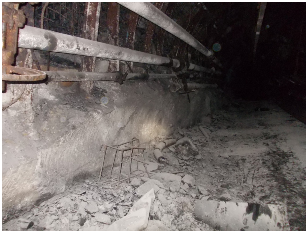
Рисунок 1.9 – Стан конвеєрного штреку за лавой після підривки
