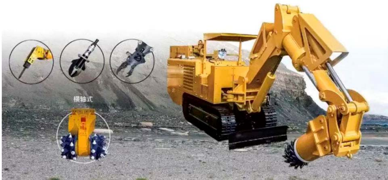
Рисунок 4.4 – Багатофункціональна машина для ремонту гірничих виробок WPZ-30/400
