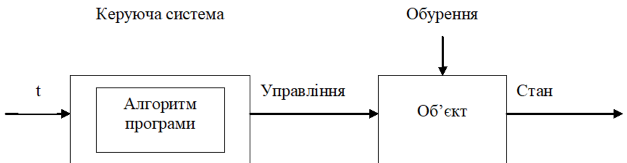
Рис. 5.1. Принцип розімкнутого управління
