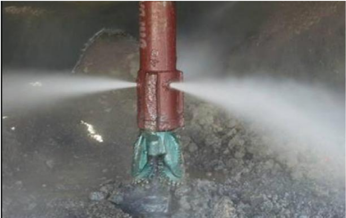
Рисунок 5.2. - Водовідділювач не дозволяє воді потрапити на наконечник бура
