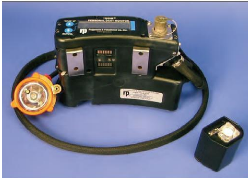
Рисунок 2.2. - персональний прилад для вимірювання запиленості в реальному часі
