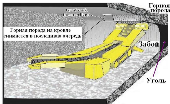
Рисунок 4.2. - Зміна послідовності руйнування вугільного пласта може зменшити запиленість
