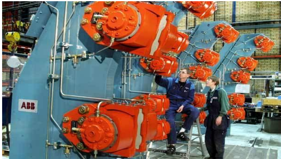
Рисунок 1.10. Фото автоматизованої шахтної підйомної машини
