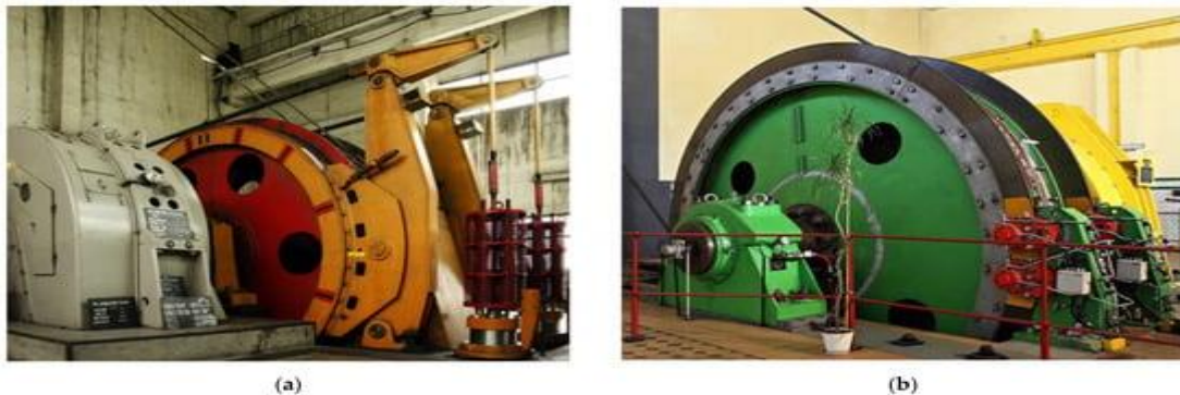
Рисунок 3.2. Типи гальм, що використовуються в шахтних підйомних системах: (a) барабанно-колодкова гальмівна система; (b) дисково-колодкова гальмівна система.
