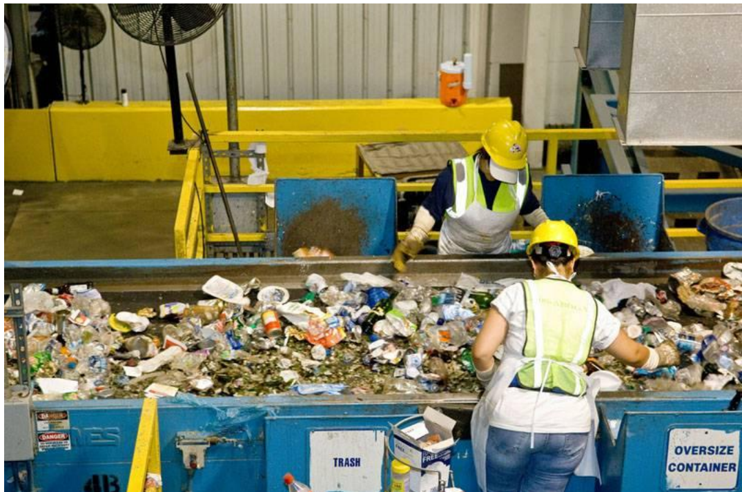
Рисунок 3.2 – Сміттєпереробний завод: загальна схема (а), ділянка ручного сортування (б)
