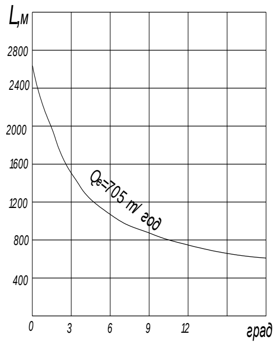
Рисунок 2.13 – Графік залежності продуктивності конвеєра ЗЛ100У від кута його встановлення та довжини
