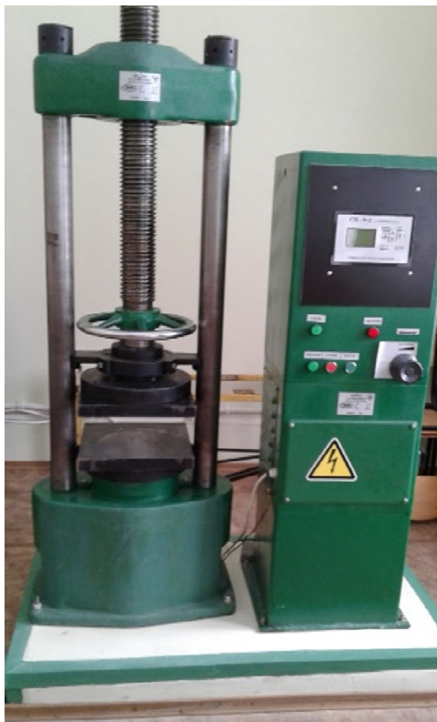
Рис. 1. Фото експериментального обладнання (прес ГП-50) для визначення деформаційних характеристик охоронних споруд.
