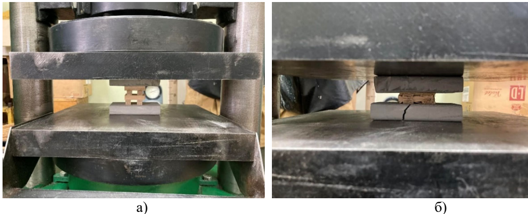
Рис. 2. Фото експериментального зразка у вигляді моделі дерев'яного костра: а) до стиснення; б) після стиснення.
