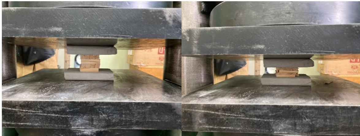
Рис. 5. Фото експериментального зразка у вигляді моделі накатного костра з дерев'яних шпал: а) до стискання; б) після стиснення.
