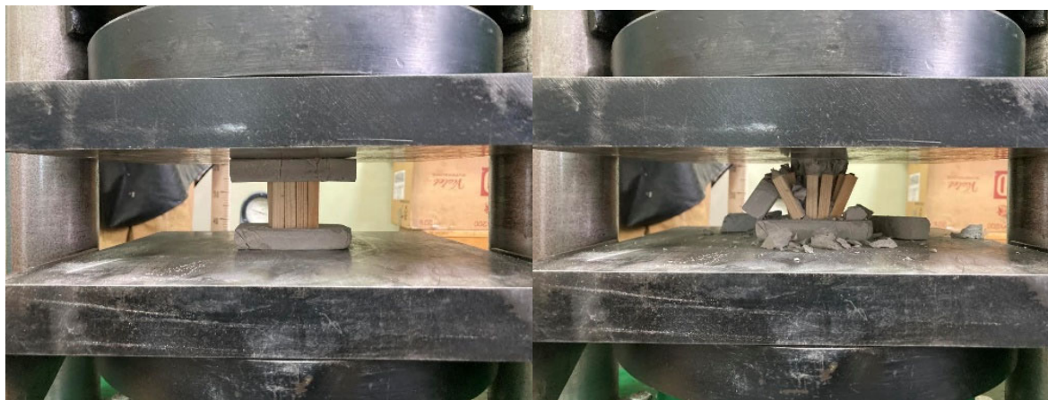
Рис. 8. Фото експериментального зразка у вигляді моделі з дерев'яних стояків: а) до стиснення; б) після стиснення.
