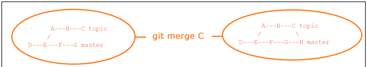
Рисунок 3.25 – Принцип роботи команди «git merge» системи «Git»
