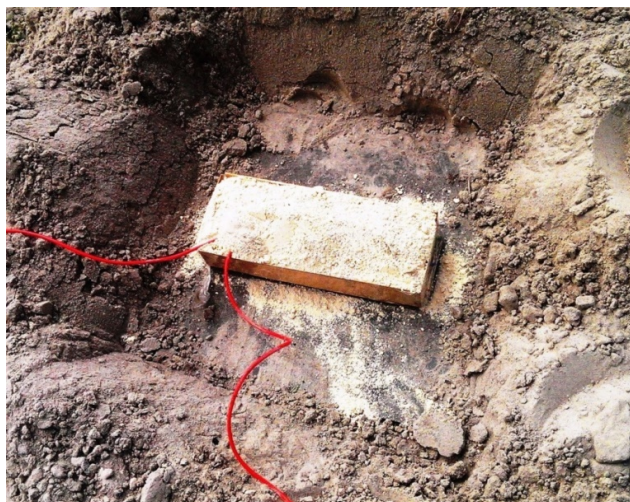
Рисунок 4 – Пластина матеріалу Guardian 500 зі встановленим зарядом вибухової речовини та детонатором
