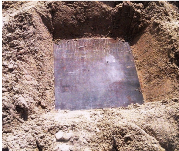
Рисунок 2 – Пластина матеріалу Guardian 500, заглиблена у піщаний ґрунт
