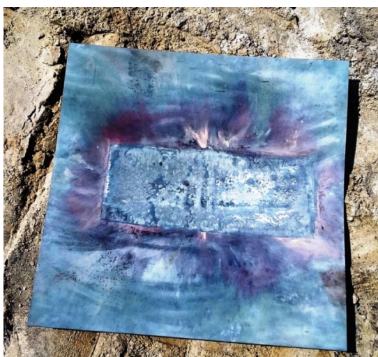
Рисунок 5 – Дослідна пластина, деформована після вибухового навантаження
