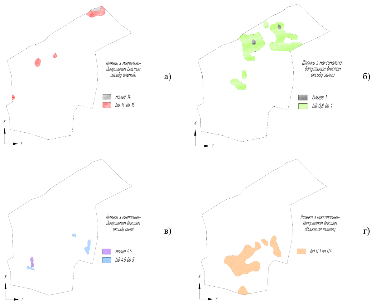
Рисунок 2 – Ділянки Йосипівського родовища каоліну з відхиленнями за: а – вмістом оксиду алюмінію; б – вмістом оксиду заліза; в – вмістом оксиду калію; г – вмістом двоокису титану
