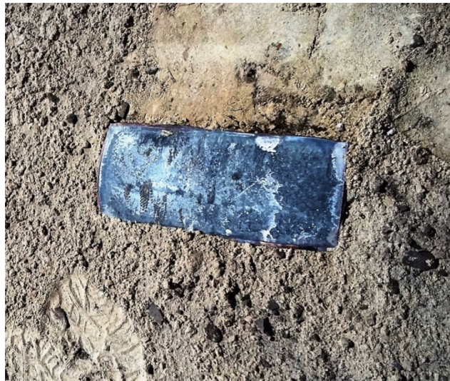
Рисунок 3 – Пластина-ударник зі сталі 110Г13Л після вибуху
