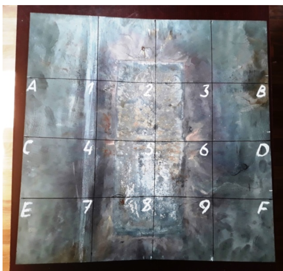
Рисунок 6 – Розташування вузлових точок контролю прогинів досліджуваної пластини
