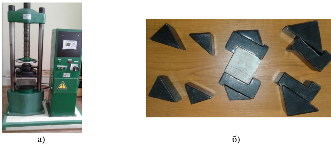
Рисунок 4 – Гідравлічний прес П-50 з максимальним зусиллям 50 тонн (а), металеві матриці з кутом нахилу 15°, 30° та 45° (б).
