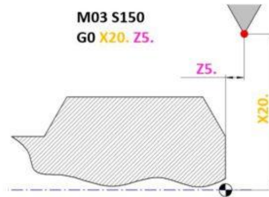
Рисунок 2.14 – Вибір стартової точки циклу G96
