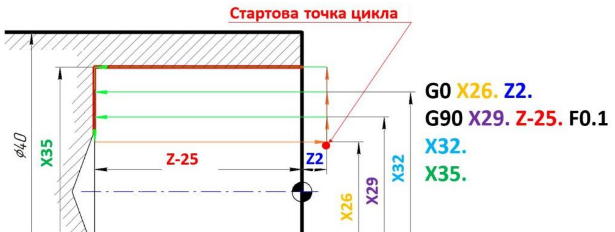
Рисунок 2.3 – Приклад програмування циклу G90 для операції розточування
