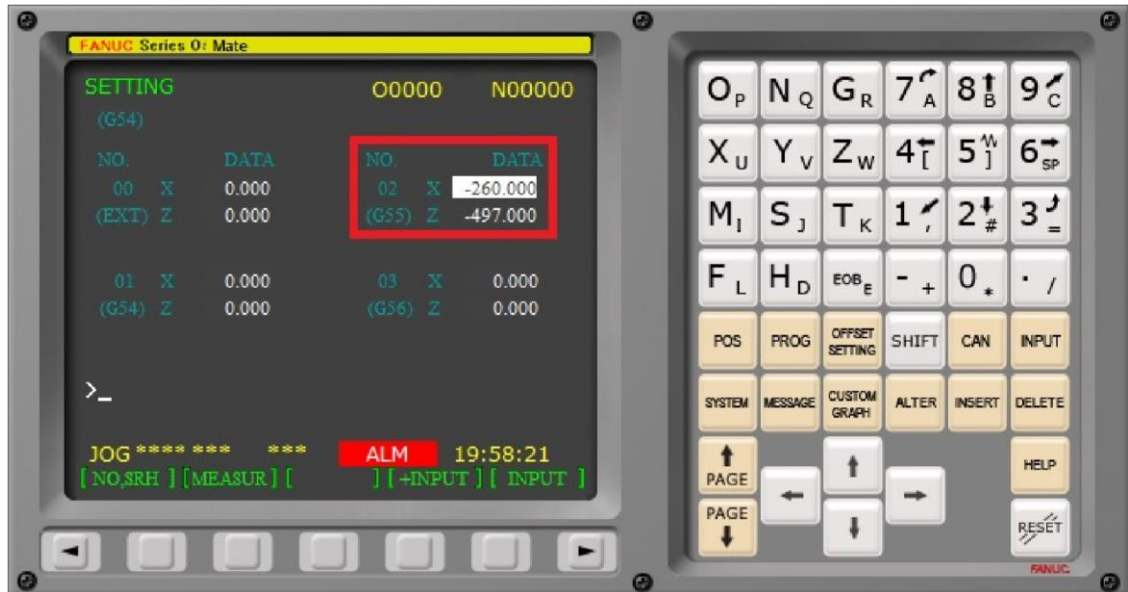
Рисунок 1.24 – Задання системи координат заготовки
