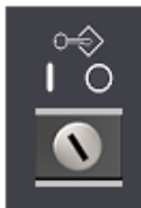
Рисунок 1.9 – Замок блокування можливості редагування програми
