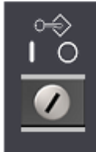
Рисунок 1.10 – Замок блокування можливості редагування програми в положенні розблокування
