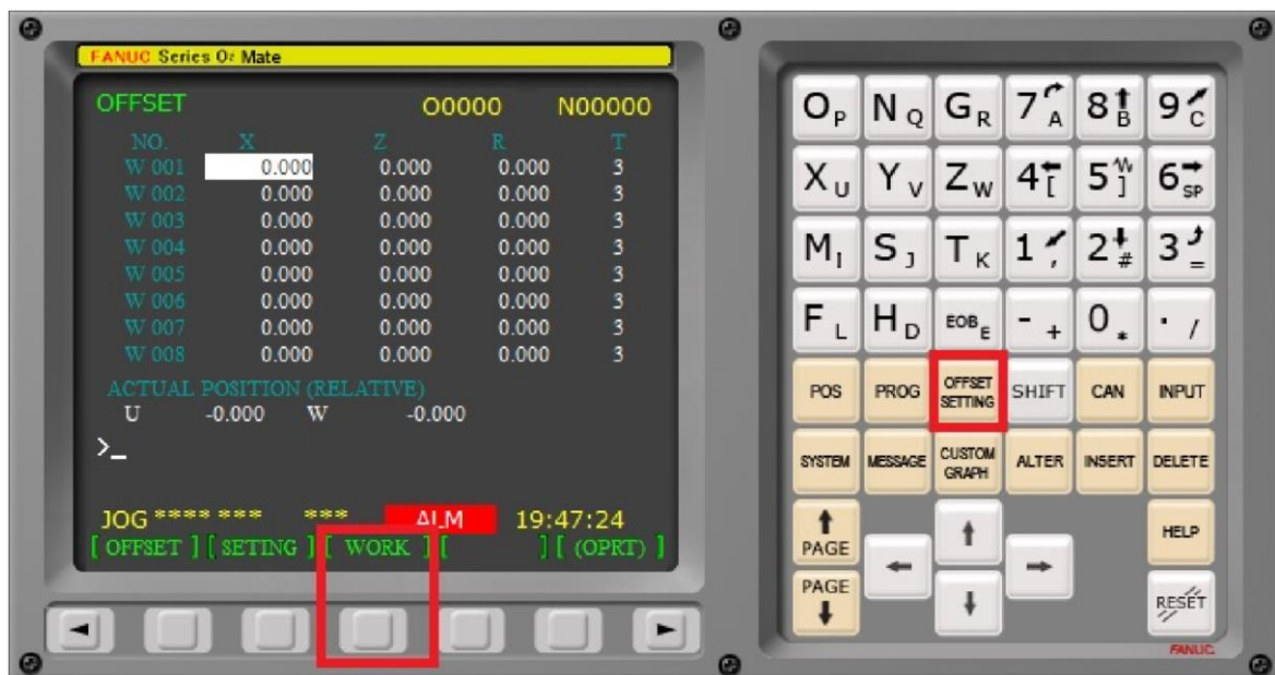
Рисунок 1.23 – Вибір режиму корекції «WORK»
