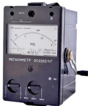
Рисунок 1 - Мегомметр – прибор для визначення електричного опору
