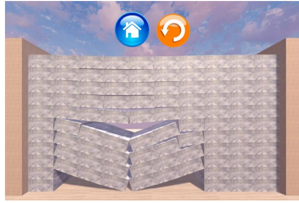
Первинне обвалення при «потужності пласта» рівного двом висотам блоку
