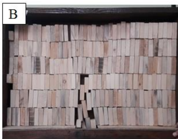
Рисунок 3 – Фізичне моделювання процесу утворення склепіння структурно-блочного масиву над виробленим простором з різними способами укладання блоків гранню а в моделі: А – по осі x; Б – по осі y; В – гранню а по осі z; Г – комбінована укладка блоків.
