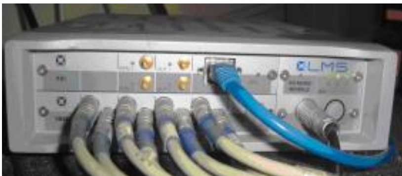
Рисунок 1 – Аналізатор LMS SCADAS Mobile
