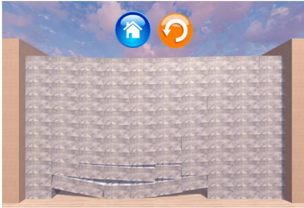
Первинне обвалення при «потужності пласта» рівного одній висоті блоку
