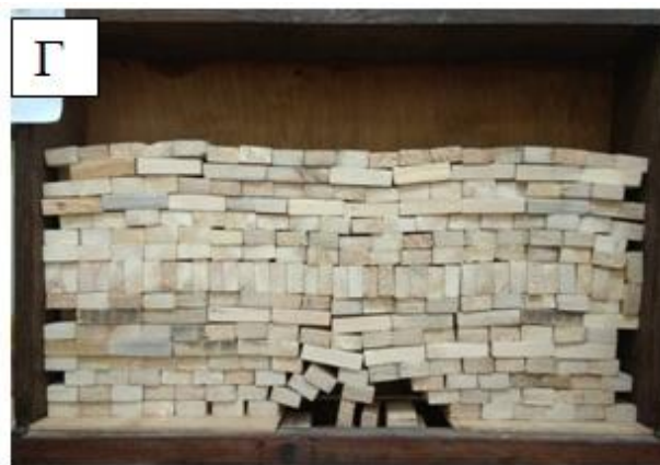
Рисунок 3 – Фізичне моделювання процесу утворення склепіння структурно-блочного масиву над виробленим простором з різними способами укладання блоків гранню а в моделі: А – по осі x; Б – по осі y; В – гранню а по осі z; Г – комбінована укладка блоків.
