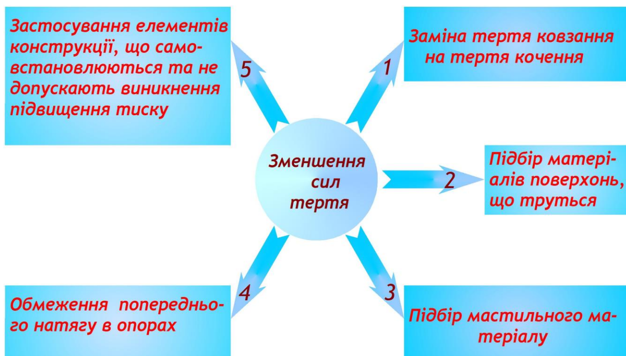
Рисунок 15.5 - Методи зменшення сил тертя при заданих навантаженнях
