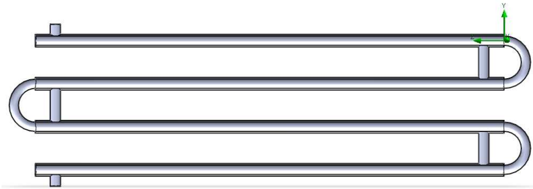
Рис. 1. Геометрична модель теплообмінника типу «труба в трубі»
