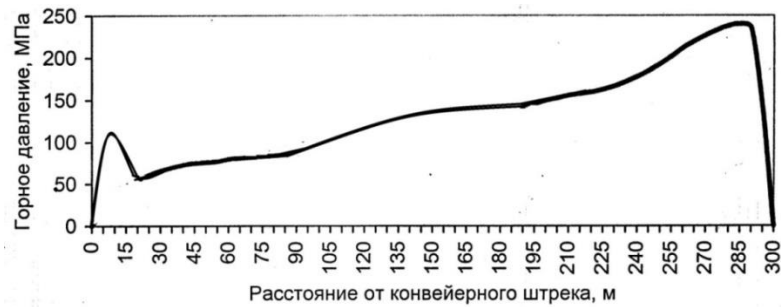
Рисунок 4 – Розподіл гірського тиску по довжині вибою у 2-й лаві центрального бремсбергу пласта \ell_1 за розрахунками на основі теорії пружності
