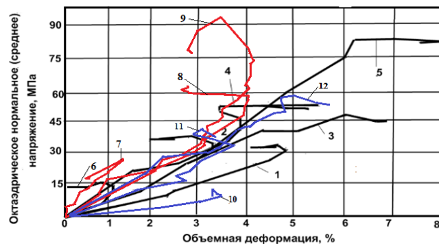
Рисунок 6- Діаграма «середнє напруження-об'ємна деформація» при критичному переході третього роду
