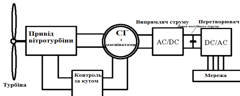
Рис.1 . Структурна схема керування вітрогенератором
