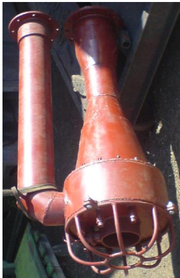
Рисунок 2- Грунтозабірний пристрій СГЗ 300-120
