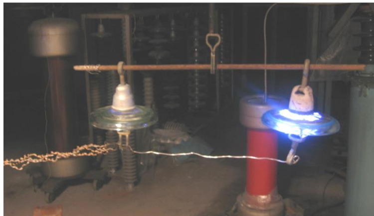
Рисунок 1 – Слева – стандартный изолятор, справа – разрядник – индикатор, находящиеся под одним напряжением
