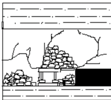
Рисунок 1 – Обвалення покрівлі дрібними фракціями.
