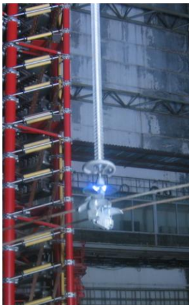
Рисунок 3 – ЛК330+U120-индикатор. Имитация частичного пробоя ЛК, U_{\text{исп}} = 200 \div 210 \text{ кВ} .
