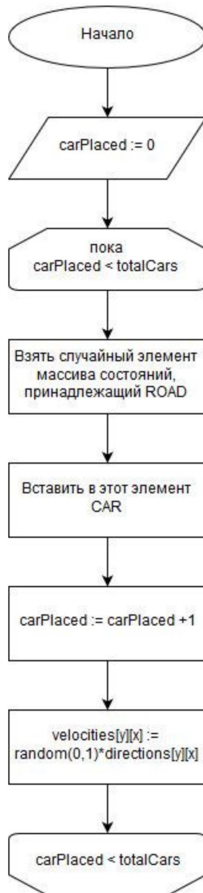
Рисунок А.3 – Блок-схема заполнения матрицы автомобилей (CAR)
