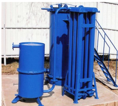
Рисунок 1 – Установка для отримання піролізного пального ТОВ "Металіст-Кременчук".
