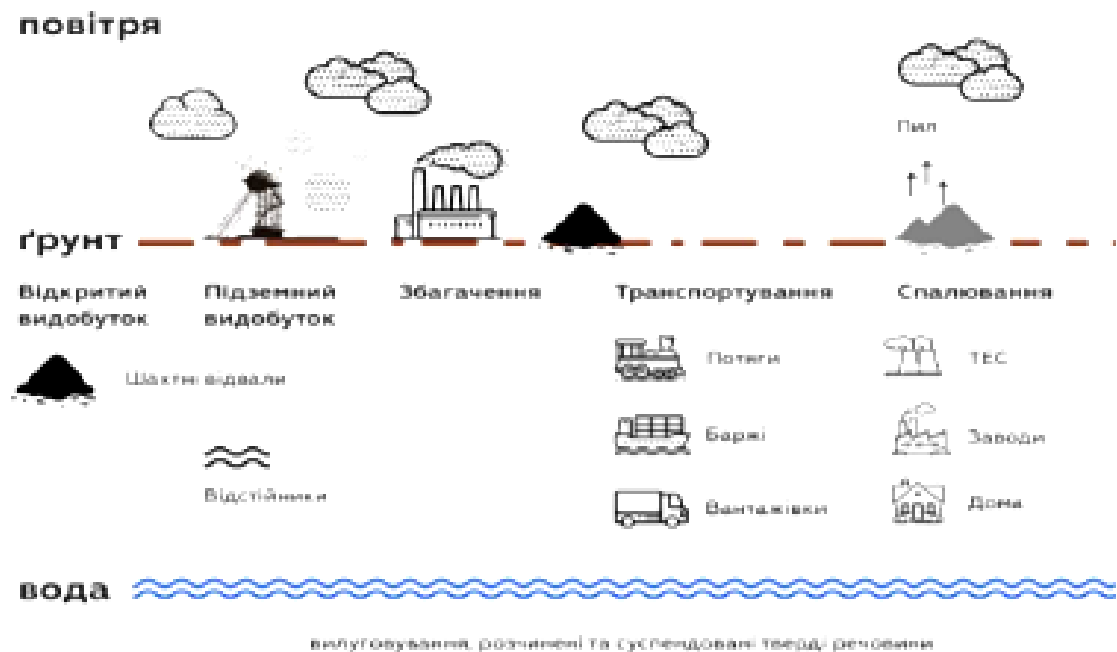
Рис. 3.2 – Механізм впливу вугільного пилу на довкілля під час видобутку, транспортування, зберігання та переробки вугілля.
