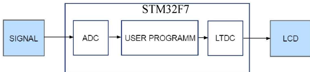
Рисунок 1 – Структурна схема апаратної реалізації ШПФ на мікроконтролері
