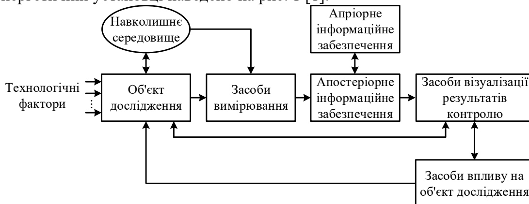
Рисунок 1. Структурна процесу автоматичного контролю зміни параметрів спалювання твердого палива
