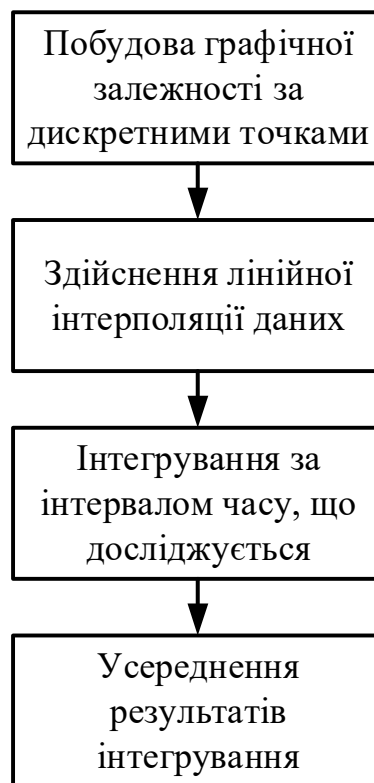
Рисунок 3.2 – Блок-схема алгоритму визначення середнього значення амплітуди структурного шуму
