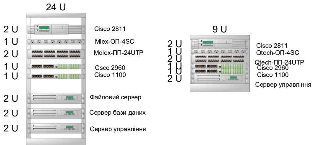
Рисунок 3.1 – Схема розміщення устаткування
