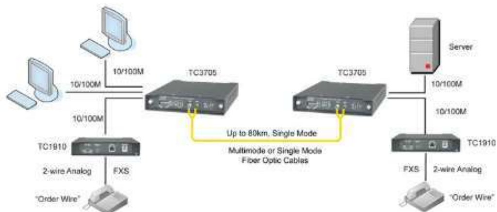
Рисунок 2.4 – Приклад побудови Switch Ethernet мережі
