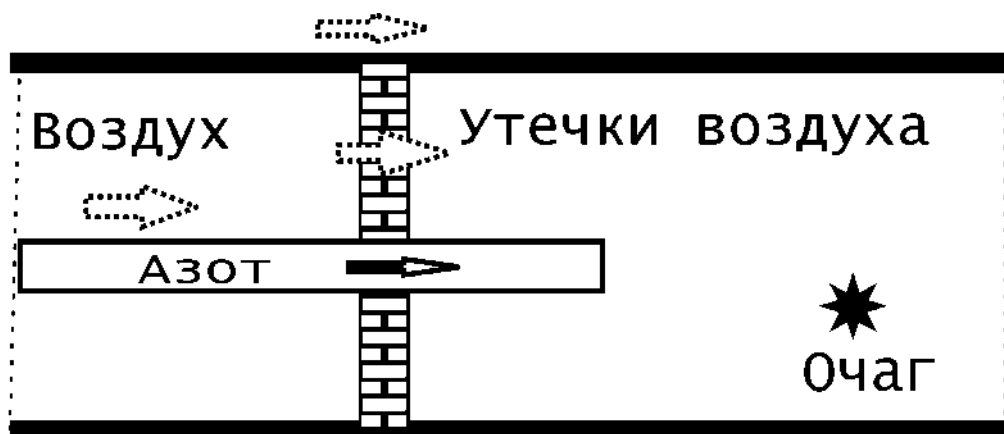
Рисунок 2.1 - Схема подачі інертного газу до центру горіння з однією перемичкою
