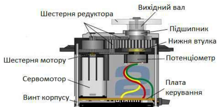
Рисунок 1.4-Конструкція сервопривода
