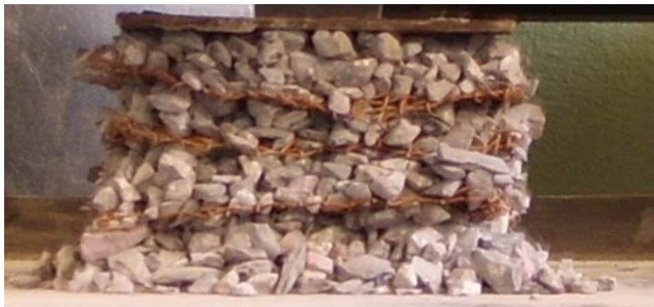
Рис. 1. Общий вид армированной бутовой опоры в структурной модели
