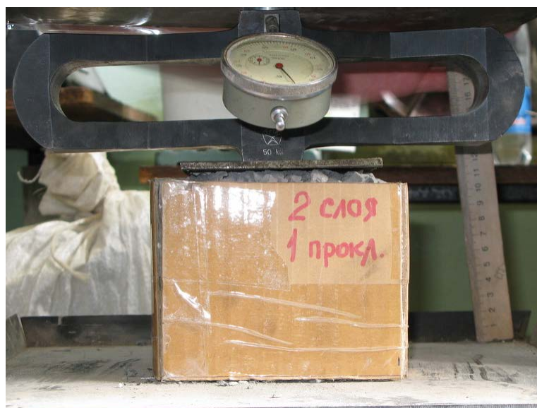
Рис. 4. Общий вид моделируемого объема в опалубке перед началом отработки
