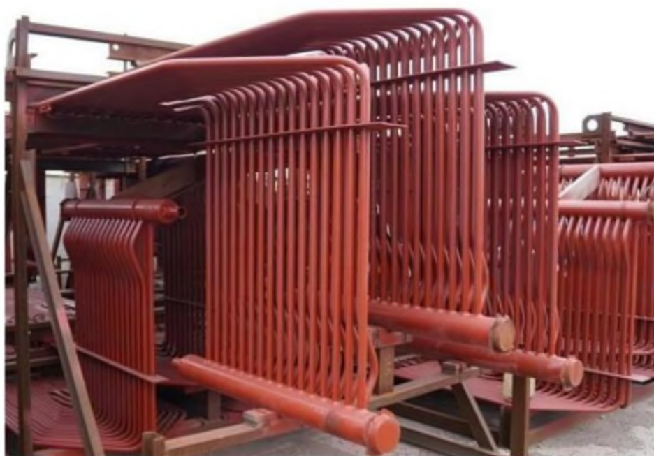
Рисунок 1.2 – Схема трубок пароперегрівача
