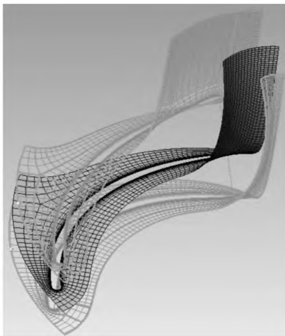
Рисунок 4.11 – Розмірна сітка навколо спроектованих лопатей відцентрового робочого колеса
