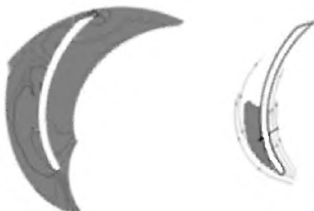
Лінії току потоку та моделювання зміни статичного тиску навколо лопаті при збільшених витратах
