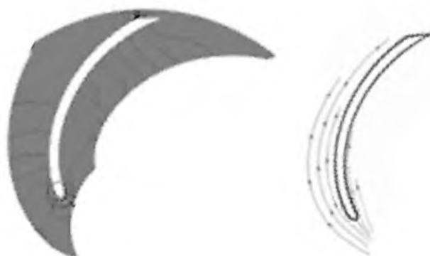
Лінії току потоку та моделювання зміни статичного тиску навколо лопаті
