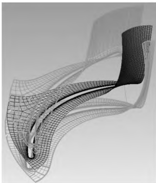
Розмірна сітка навколо спроектованих лопатей відцентрового робочого колеса
