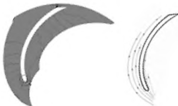
Рисунок 3.3 – Лінії току потоку та моделювання зміни статичного тиску навколо лопаті
