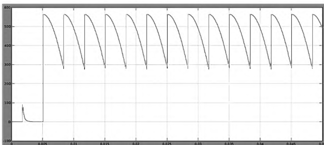
Форма керуючої напруги при куті відкриття тиристора \alpha = 30^\circ
