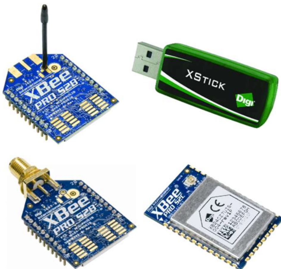
Рисунок 4.2 – Зовнішній вигляд типових серійних модулів на базі технології ZigBee
