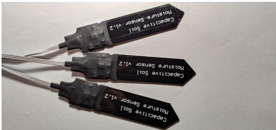
Рисунок 1.8 – Ємнісний датчик вологості ґрунту від DFRobot
