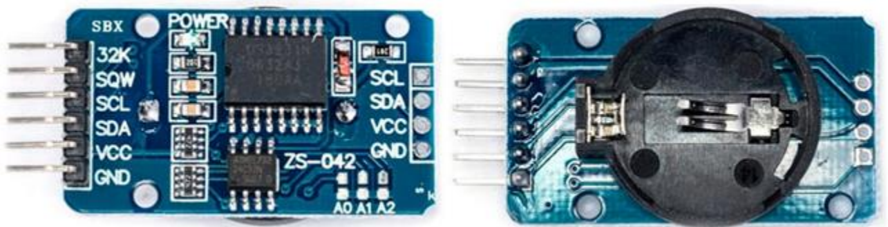
Рисунок 1.10 – Модуль реального часу DS3231
